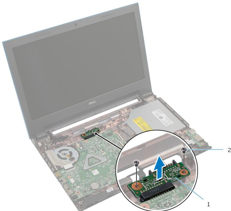
1 placa del conector de la batería
